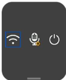
Mit dem Shortcut-Modus können Sie die WiFi- und Audioaufnahmefunktionen der Kamera schnell ein- und ausschalten sowie die Kamera schnell ausschalten. Tippen Sie in diesem Modus auf die gewünschten Symbole auf dem Bildschirm, um die entsprechende Funktion schnell auszuführen.
