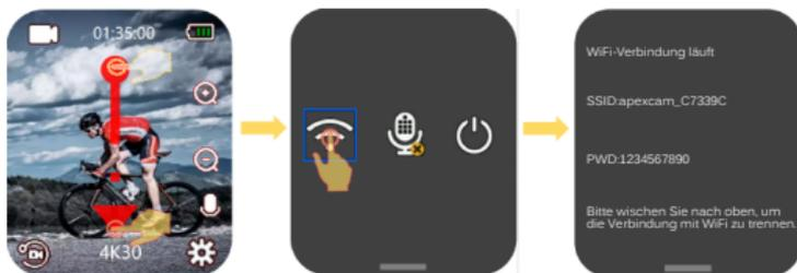
**Schritt 3: Schalten Sie die mobilen Daten aus und verbinden Sie die Kamera und den Smartphone mit dem WLAN-Netzwerk.**
