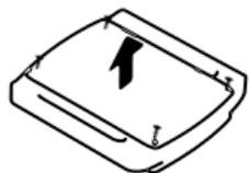
**Étape 1:** Retirez les 4 vis à l'arrière de la télécommande avec un tournevis de 1,8 mm et vous pouvez l'ouvrir.
