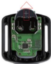
Nota: NO girar la PCB para evitar invertir las funciones de la cámara y los botones de video.
