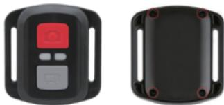
**2** Retirar otros 4 tornillos en la placa PCB.
