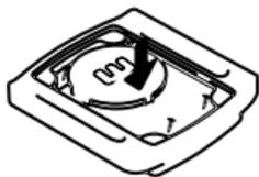
**Paso 5:** Vuelva a instalar los 4 tornillos en la placa.
