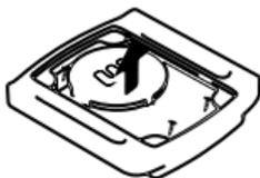
**Paso 2:** Retire otros 4 tornillos en la placa de circuito.
