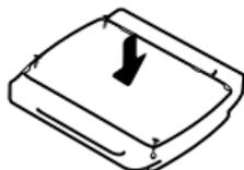
**Paso 6:** Vuelva a instalar los 4 tornillos en la cubierta.
