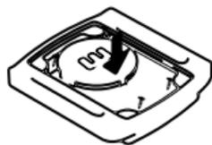
**ステップ5:** 4本のネジをすべてPCBボードに戻します。
