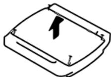
**ステップ1:** 先端1.8mmのドライバー（付属していません）を使って、リモコンの裏蓋にある4本のネジを外し、開けることができます。
